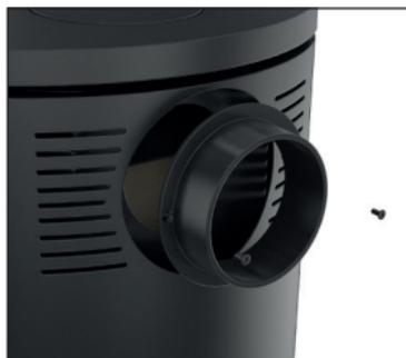
6. Den Stutzen des Rauchabzuges an die Rückseite des Körpers der Feuerstelle anschrauben (an die Stelle, wo sich früher die Blende des Rauchabzuges befand).
