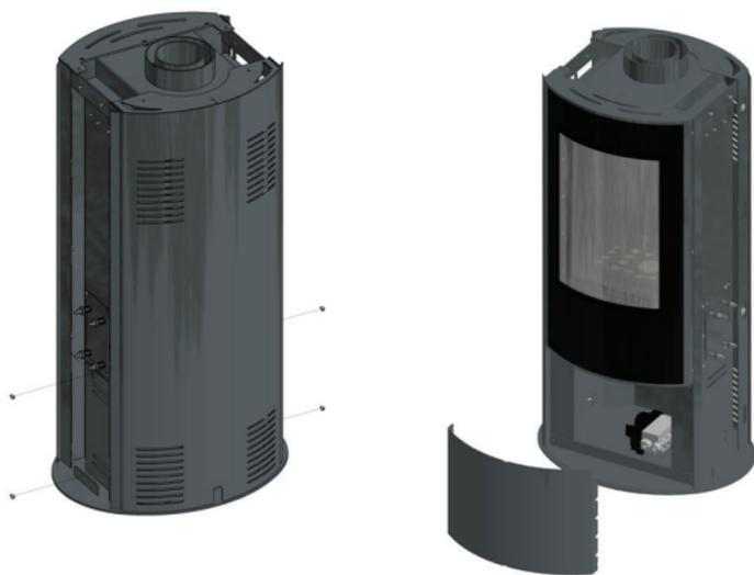
Fig. 9 Méthode de retirer la porte inférieure du chauffage RO/G
