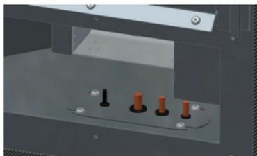
Fig. 7 Méthode de faire passer et sceller le conduit de la capillaire, du conduit de la magnéto, du tuyau du brûleur principal et du tuyau du brûleur de contrôle du chauffage RO/G.
